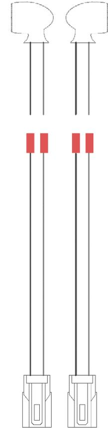
**Achtung!** Beim Anschließen von nur zwei Kellermann Blinkern, benutzen Sie die Stecker mit dem Gehäuse. Sobald alle vier originalen Blinker gewechselt werden, verwenden Sie die zusätzliche Kabelpeitsche.
